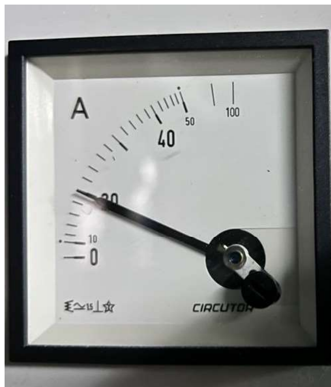
Figura 2-21. Detalle del amperímetro
